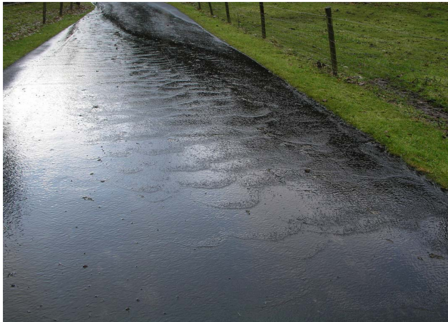
Figur 23: Roll waves på en asfaltvei under regnvær (Bildet har blitt kopiert fra http://www.maths.ox.ac.uk/~fowler/pictures/gallery.html ).
