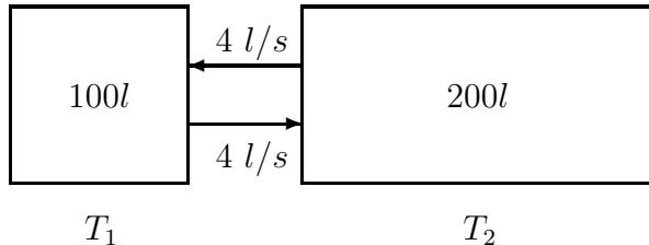
Ved tidspunktet  $t = 0$  inneheld tank  $T_1$   $100\text{ l}$  reint vatn, tank  $T_2$  inneheld  $200\text{ l}$  vatn med  $30\text{ kg}$  salt oppløyst. Salttoppløysinga strøymer mellom tankane med ein fart på  $4$  liter pr. sekund. Finn saltmengdene  $x_1(t)$  og  $x_2(t)$  i dei to tankane for alle  $t > 0$ .
